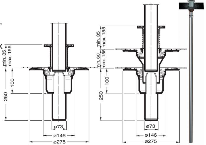
**System-Variante mit Sieb für Balkongeschosse und mit Wärmedämmung**
